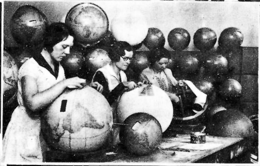
La máquina impresora, de factura especial, que imprime las cintas con los nombres de los lugares geográficos utilizados en el "Mundo Globo", y la forma en que son preparadas las nuevas esferas, llamadas a revolucionar la enseñanza de la Geografía, pueden verse en estas fotos.
